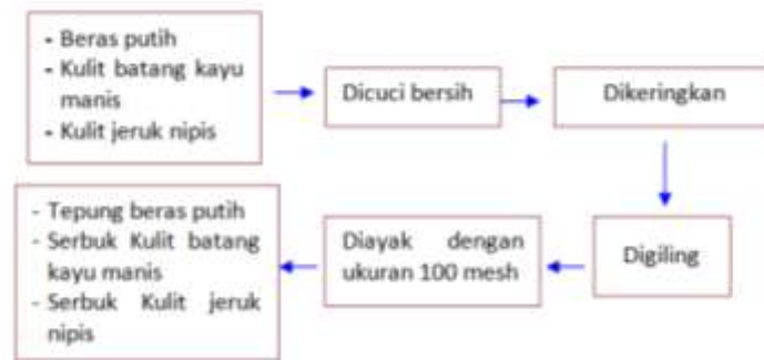
Gambar 2. Diagram Proses Pembuatan tepung beras putih, serbuk kulit batang kayu manis dan kulit jeruk nipis
